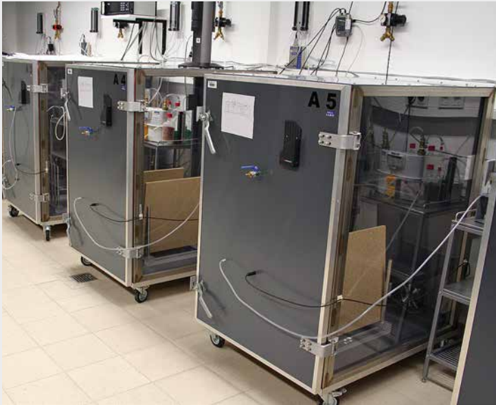
Testkamer in de uitvoering van 1 m 3 van het Fraunhofer-instituut WKI
